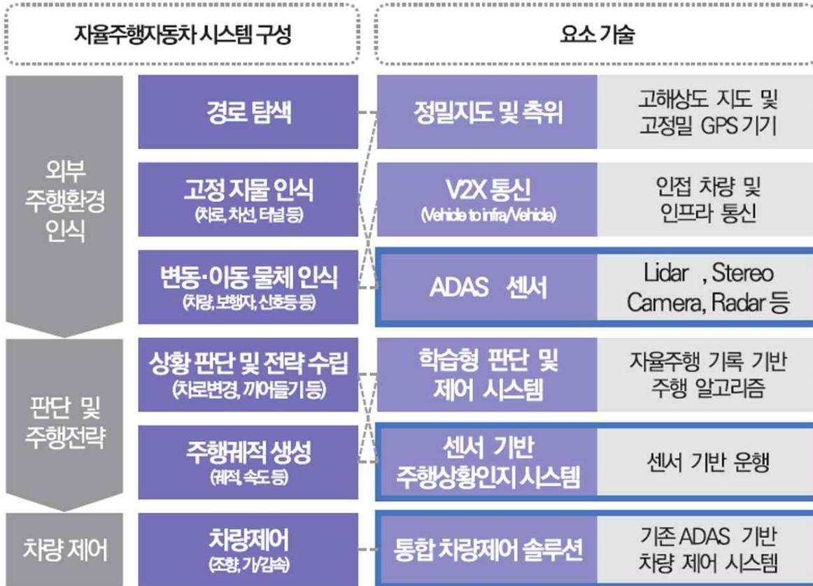
주) -V2X(Vehicle to Exverything): 차량과 다른 차량, 인프라 등과 통신하며 정보를 교환하는 기술로 차량-차량(V2V), 차량-인프라(V2I), 차량-보행(V2P), 차량-모바일기기(V2N) 등이 있음
