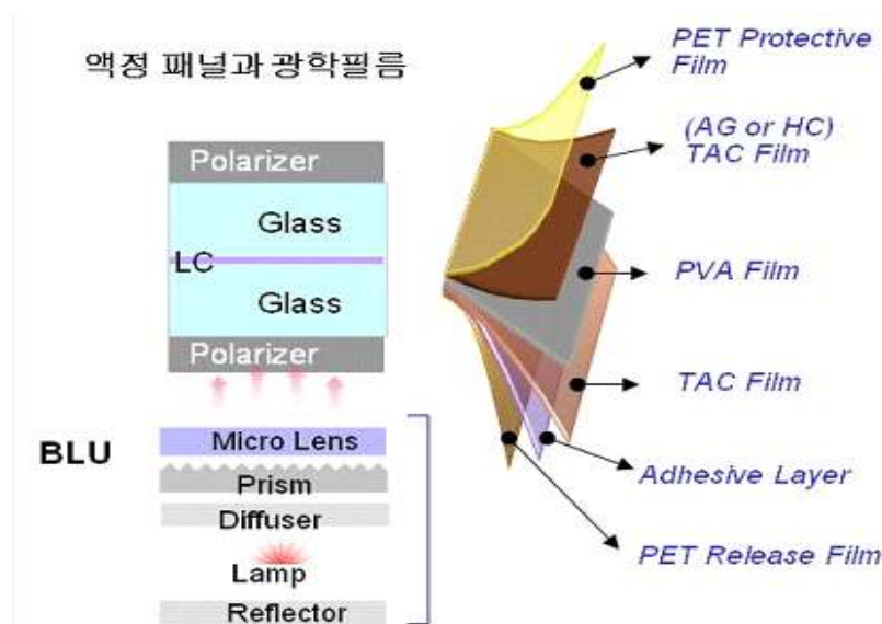
〈그림 9〉 LCD 원리와 광학필름
